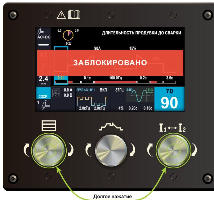
Рис. 9 – Принцип блокировки панели управления
