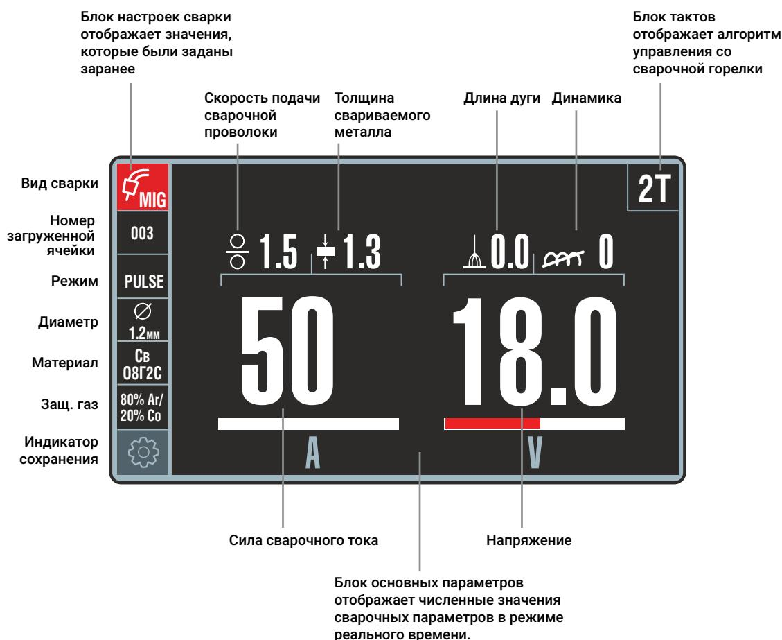
Рис. 19 – Блоки Главного экрана панели управления
