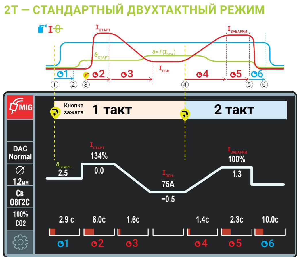
Рис. 35 – Циклограмма работы в режиме 2T и условный график от времени
