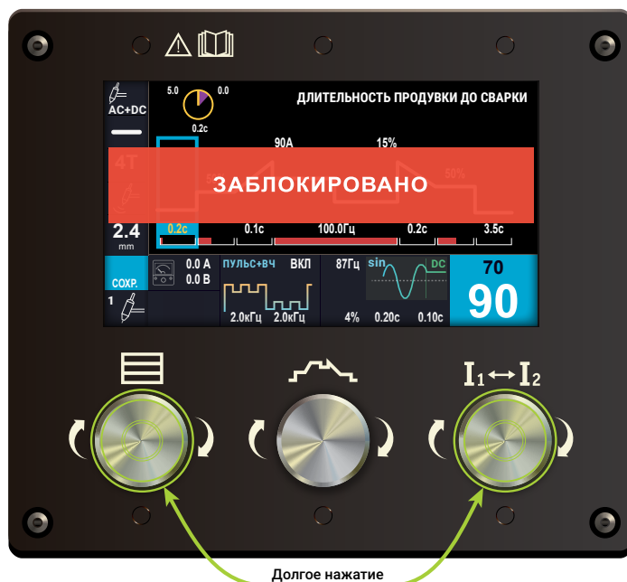
Рис. 9 — Принцип блокировки панели управления
