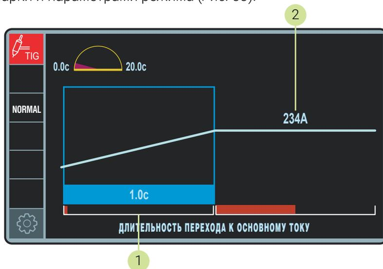
Рис. 33 – Экран ЦИКЛОГРАММА в режиме TIG DC
