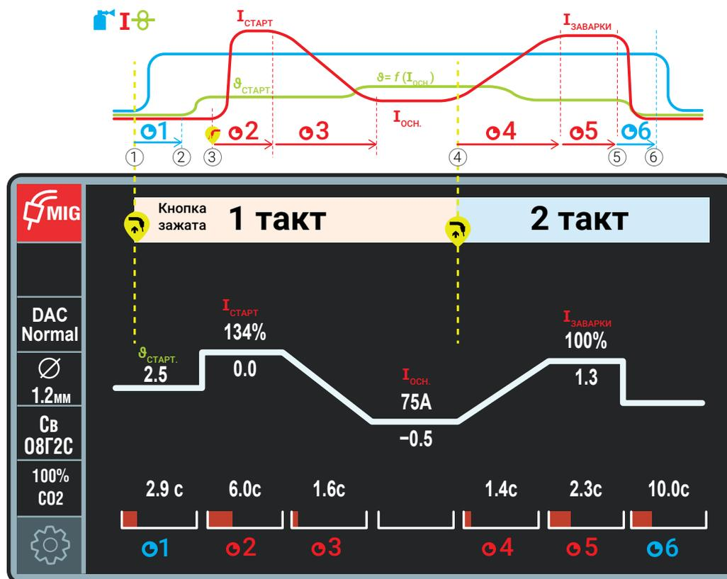
Рис. 35 – Циклограмма работы в режиме 2Т и условный график от времени
