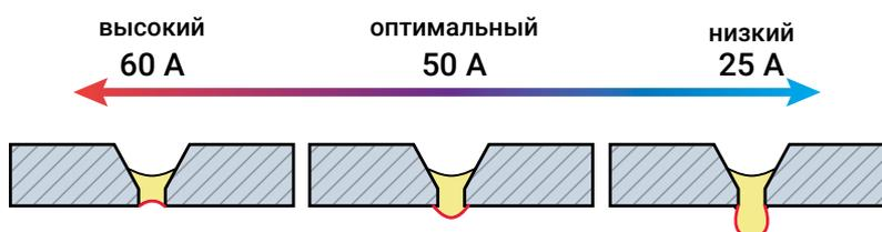
Рис. 29 – Зависимость формирования сварочного шва (линза и провар) в режиме DAC CSC от величины тока импульса и базового тока
