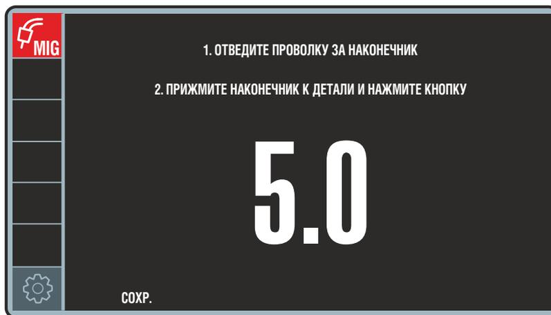
Рис. 42 – Экран КАЛИБРОВКА СВАРОЧНОГО КОНТУРА
