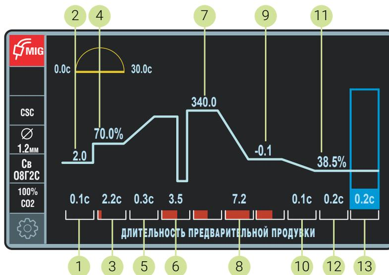
Рис. 28 – Экран ЦИКЛОГРАММА в режиме DAC CSC
