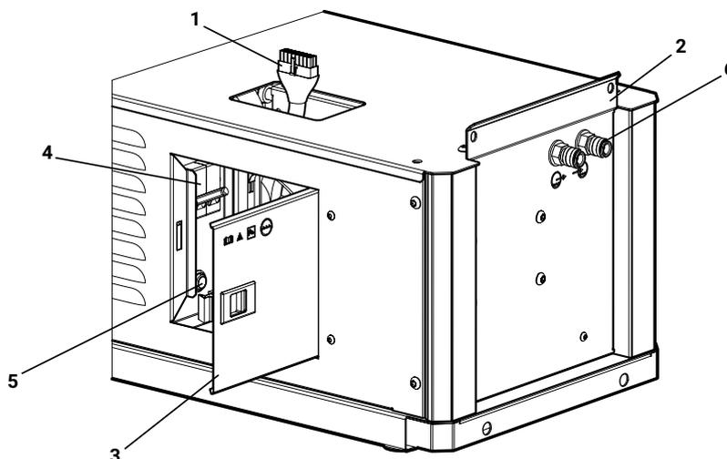
Рис. 4 – Элементы БЖО: 1 – кабель питания и управления, 2 – крепёжная пластина, 3 – боковая дверца, 4 – автомат выключения питания, 5 – кнопка прокачки жидкости, 6 – быстроразъёмные соединения линии охлаждения (БРС)
