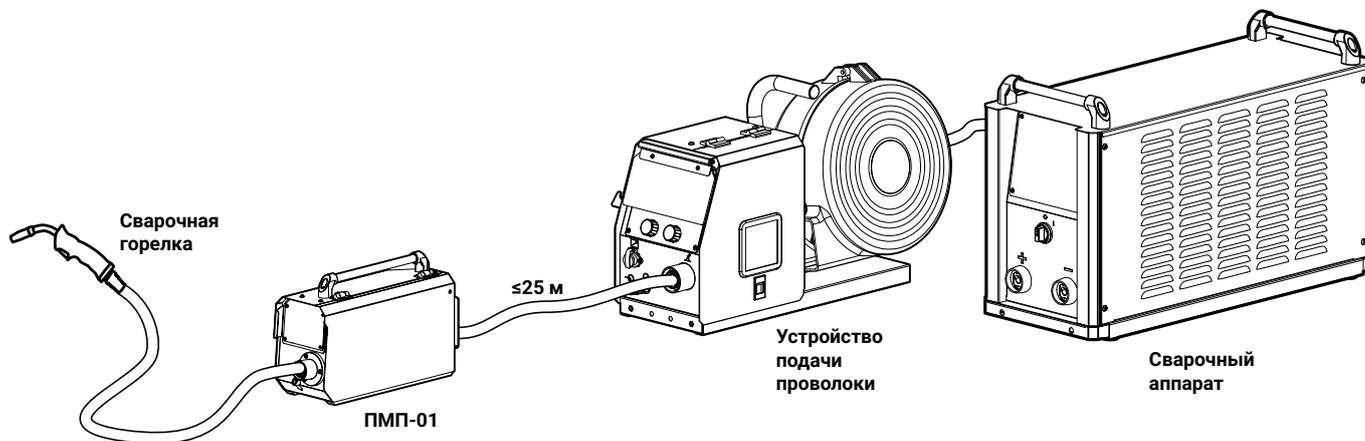
Рис. 9 – Условная схема подключения промежуточного привода
