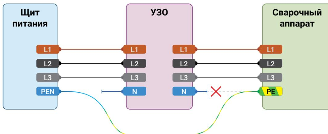
Рис. 16 – Схема подключения к системе TN-C с УЗО
