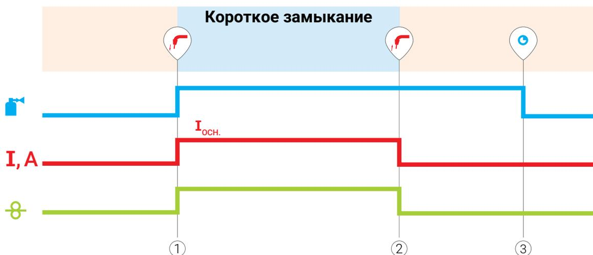
Рис. 37 – Диаграмма работы в режиме контактного зажигания дуги
