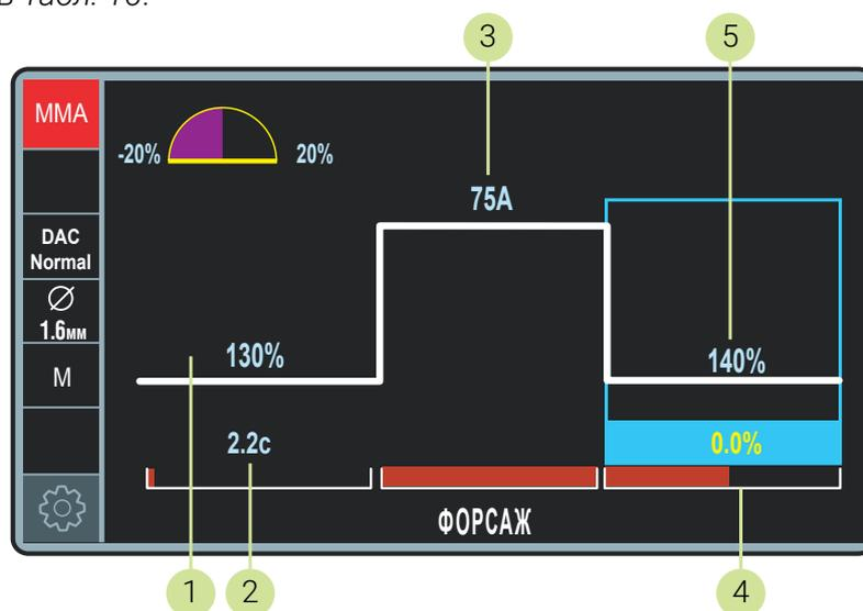
Рис. 31 – Экран ЦИКЛОГРАММА ММА в режиме DAC Normal
