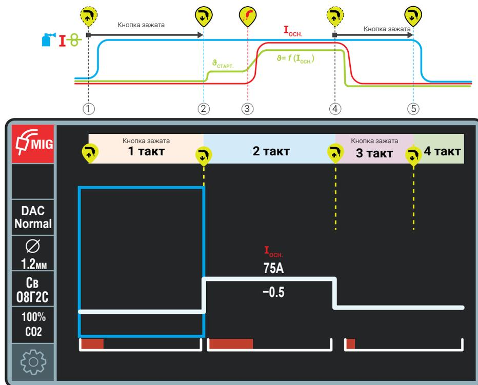
Рис. 39 – Диаграмма работы в четырехтактном режиме с продувкой газа 4ТГ
