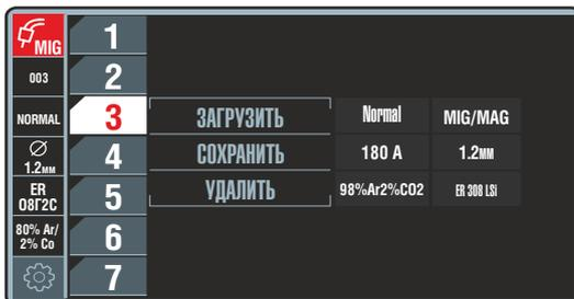
Цвет ячейки изменится с серого на белый. В столбце слева высветится номер сохранённой ячейки, а в меню – сохранённые в ячейку параметры: режим, ток, вид проволоки, защитный газ.
